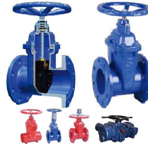
Las válvulas exclusiva o compuerta son utilizadas cuando se requiere apertura o cierre total sin estrangulación y uso poco frecuente. Presentan baja resistencia a la circulación y una mínima cantidad de fluido atrapado en la misma. Su asiento suave (EPDM) le confiere un alto grado de hermeticidad.
