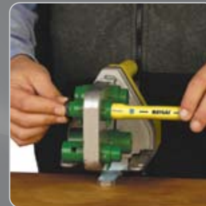
Con una primera termofusión se incorpora un buje a la capa interna del tubo
