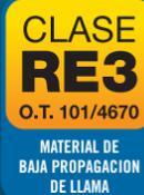
Toda nuestra línea de membranas ISOLANT® tienen incorporado un aditivo exclusivo, haciendo que nuestros productos sean de baja propagación de llama. Esta innovación está pensada para brindar mayor seguridad. Ensayos realizados en el INTI clasifican al material como de “Baja propagación de llama, Clase RE3”.
